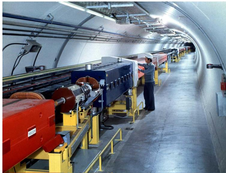
Slika 1.8: Unutrašnjost tunela kroz koji prolazi Super Proton Sinhrotron (SPS) u CERN-u.
