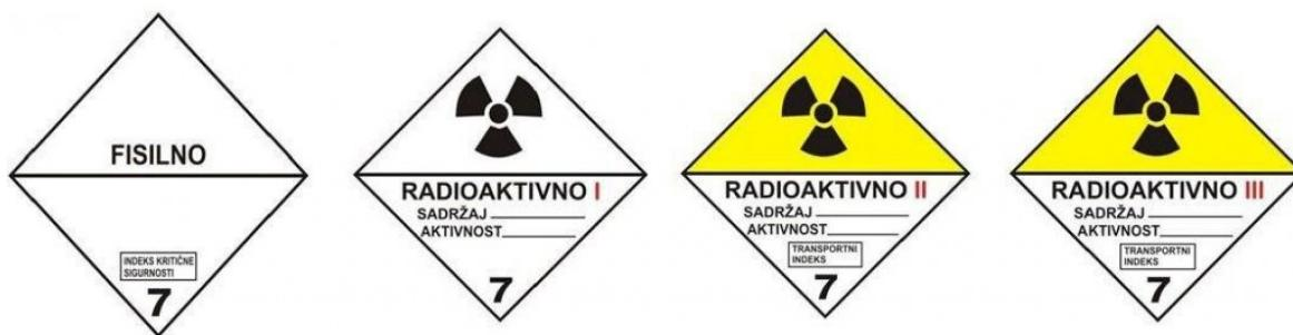
**Slika 13.** Transportne oznake radioaktivnog materijala.<sup>25</sup>
