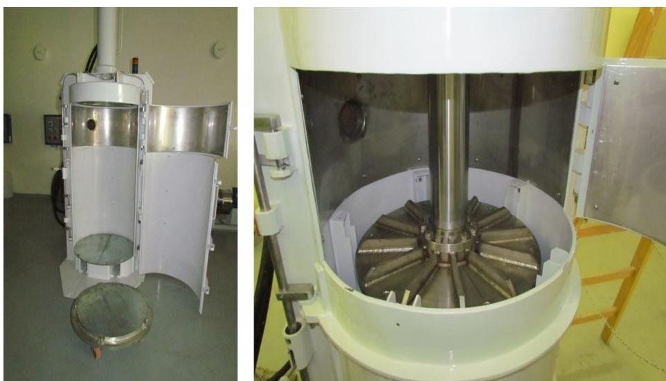
**Slika 4.** Kompaktor za kompaktiranje radioaktivnog otpada.<sup>17</sup>
