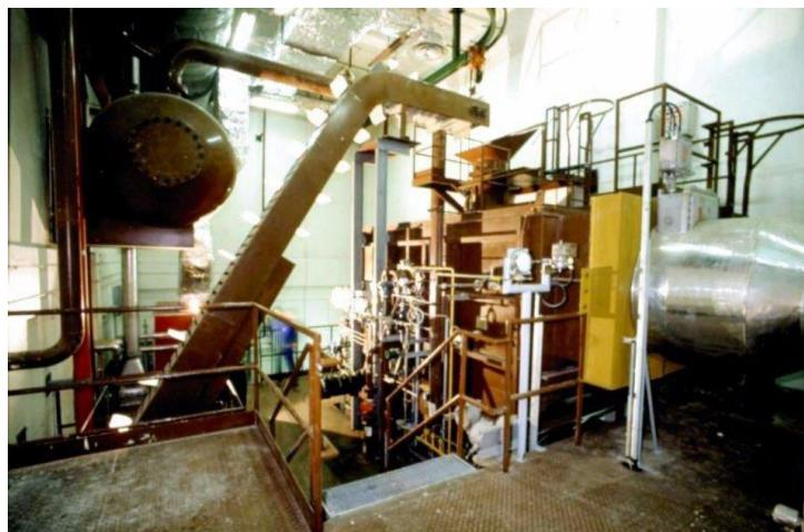
**Slika 3.** Peć unutar koje se vrši spaljivanje RAO.<sup>16</sup>
