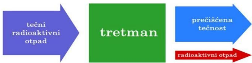
**Slika 5.** Obrada (tretman) tečnog radioaktivnog otpada.<sup>18</sup>
