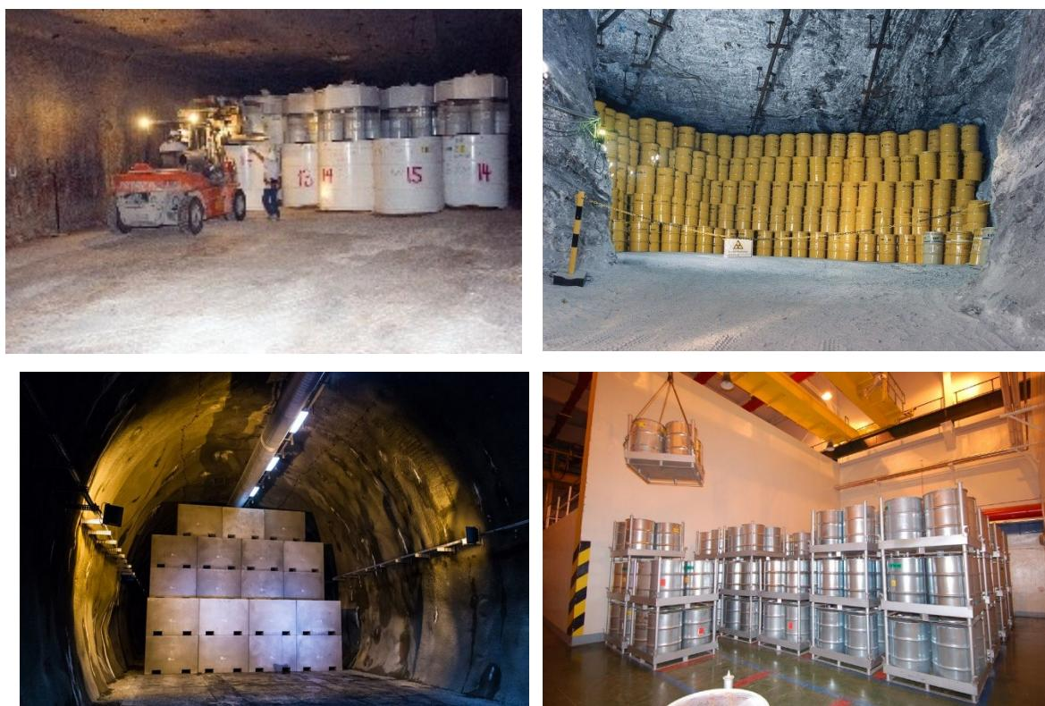
**Slika 11.** Najčešći načini skladištenja radioaktivnog otpada.<sup>23</sup>
